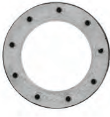
단본,상부 PILE의 두부
